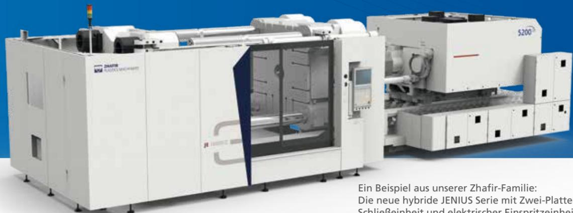
Ein Beispiel aus unserer Zhafir-Familie: Die neue hybride JENIUS Serie mit Zwei-Platten Schließeinheit und elektrischer Einspritzeinheit reicht von 3.600 kN bis 33.000 kN
